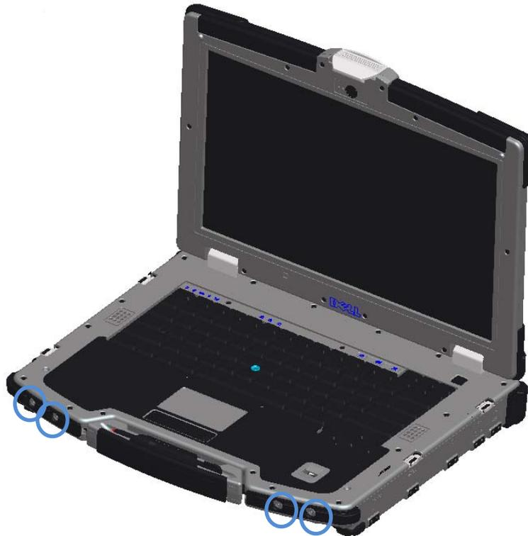
2. Installez les points de fixation de la bandoulière à l'avant de l'ordinateur à l'aide des vis retirées à l'étape 1.
